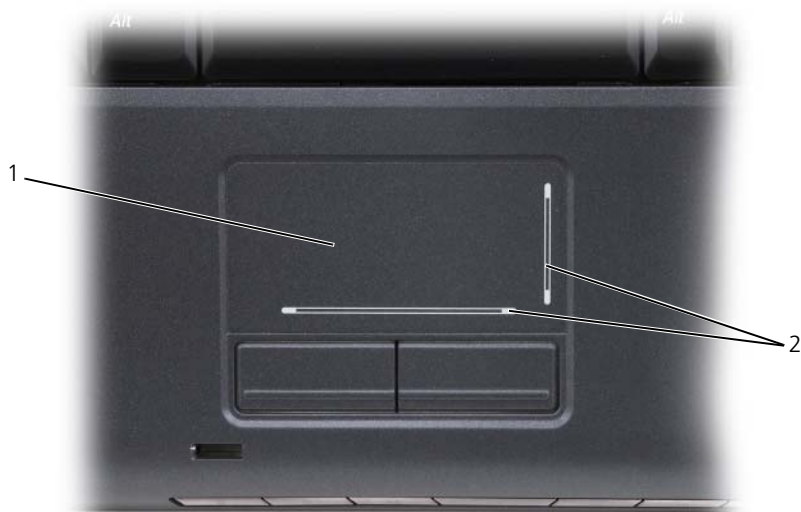
1 タッチパッド 2 スクロールゾーンを含むシルクスクリーン
